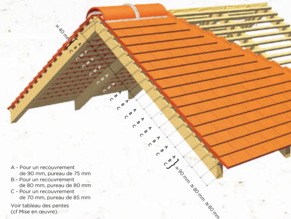
A - Pour un recouvrement de 90 mm, pureau de 75 mm
