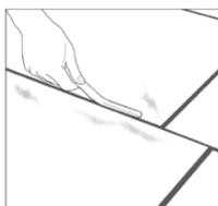
5. Pressez les joints avec un fer à rejointoyer. Remplissez les creux de Weatherpoint et pressez de nouveau.
