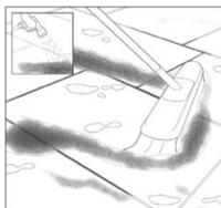
3. Balayez le produit dans les joints avec un balai à poils durs. Assurez-vous que le pavé reste mouillé à tout moment. Ainsi, le produit glissera facilement dans les joints. Balayez les joints en diagonale (45°). Assurez-vous que les joints sont tout à fait remplis. Utilisez le produit dans l'heure qui suit l'ouverture de l'emballage.
