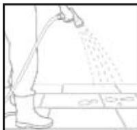
1. Arrosez le pavé jusqu'à saturation. ATTENTION – Si le pavé n'est pas bien mouillé, des tâches apparaîtront temporairement.
