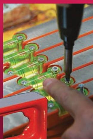
Large semelle avec chanfrein rectifiée après le traitement Epoxy. Surface parfaitement plane pour une meilleure précision.
